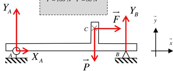
Exercices 5 et 6 : calculer à l'aide du PFS les composantes sur  $\vec{x}$  et  $\vec{y}$  de la réaction en  $A$  et de  $\vec{F}$  pour avoir l'équilibre du système dans la position donnée. Interpréter systématiquement le signe des résultats trouvés. Calculer les intensités  $\vec{A}$  et  $\vec{F}$ .
