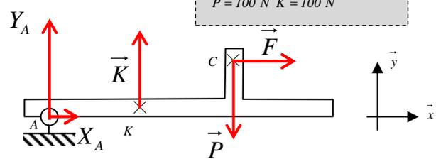
Exercices 7 et 8 : calculer à l'aide du PFS la cote  $x$  et les composantes sur  $\vec{x}$  et  $\vec{y}$  des réactions en  $A$  et  $B$  pour avoir  $Y_B = 0,5 \cdot Y_A$ . Interpréter systématiquement le signe des résultats trouvés. Calculer les intensités  $\vec{A}$  et  $\vec{F}$ .
